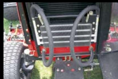
La rejilla del radiador abisagrada y el enfriador de aceite pivotante ofrecen un acceso fácil y rápido para las operaciones de limpieza.
